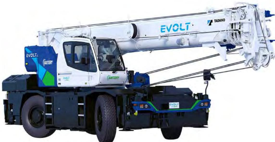
Компания Tadano Ltd выводит на рынок строительной техники внедорожный короткобазный кран Tadano EVOLT eGR-250N, оснащенный полным электроприводом.
